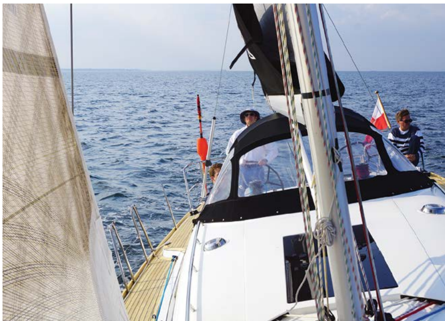
Pólpokłady są szerokie. Wzdłuż nadbudówki poprowadzono stalowe uchwyty. Oslona zejściówki i przedniej części kokpitu jest wysoka – sięga aż do bomu – ale nie ogranicza widoczności.
