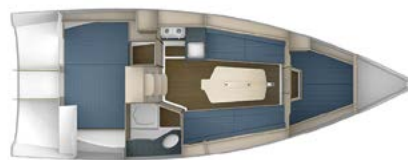
Koję w rufowej kabinnie ułożono prostopadle do osi jachtu – wejście jest z lewej strony.
