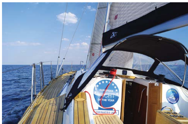
Półpokłady i kokpit pokrywa drewno tekowe. Zejściówkę zamykają dwuskrzydłowe drzwi.
