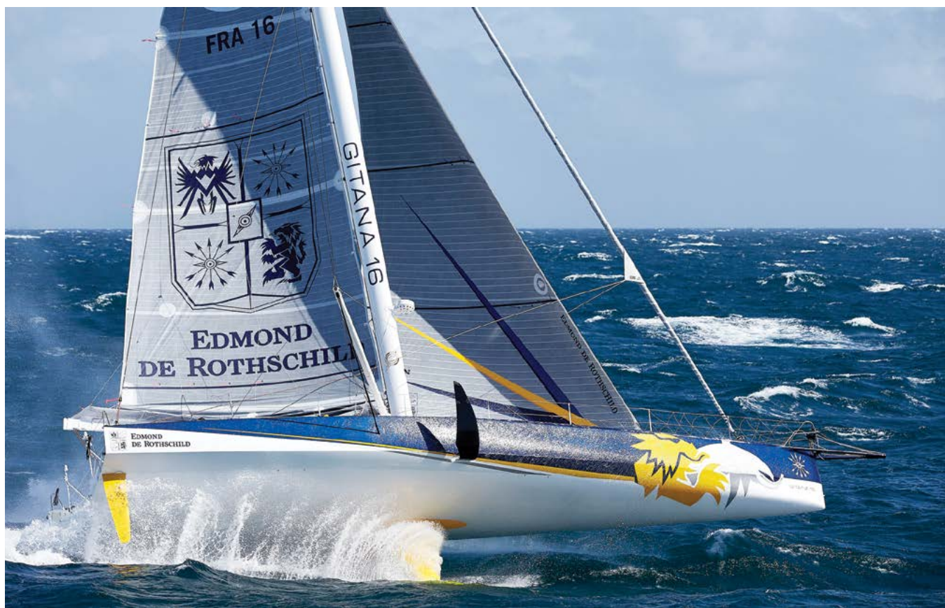
Jacht „Gitana 16” ma dwie płetwy sterowe, uchylny kil o zanurzeniu 4,5 metra oraz skrzydła wodne. Klasa IMOCA 60 podrywa się do lotu.
