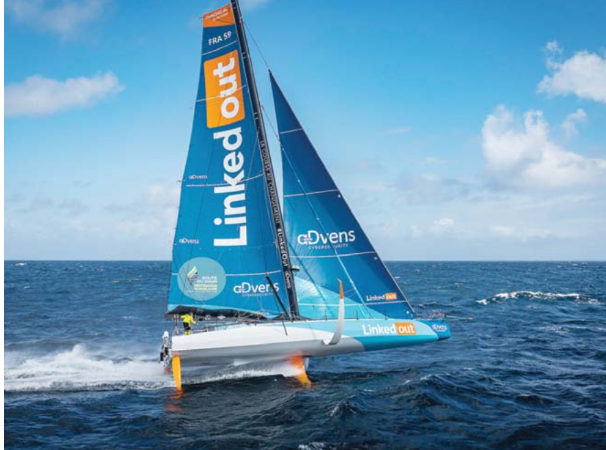
„LinkedOut” Thomasa Ruyanta ma foile o maksymalnej dozwolonej powierzchni.
