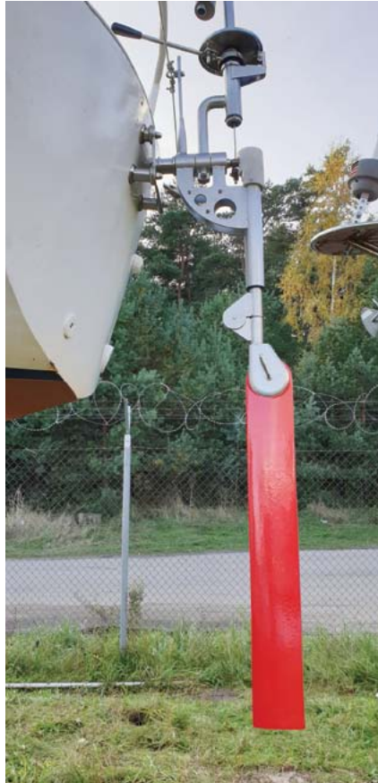
Sposób mocowania samosteru do kadłuba.
