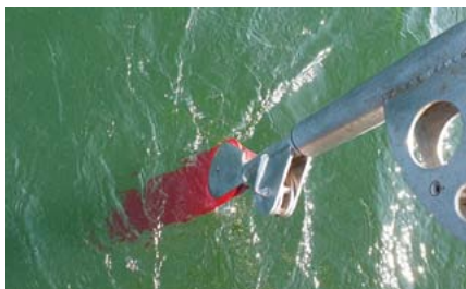
Płetwa samosteru pracująca za rufą.
