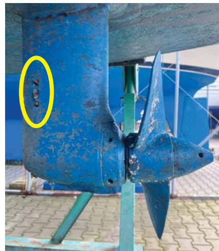
Skorupki mogą zatykać otwory do wody chłodzącej.
