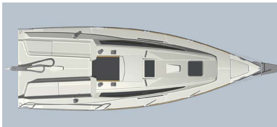
Pokład płynnie przechodzi w powierzchnie burtowe. Stoprelingi nawiązują do drewna tekowego.
